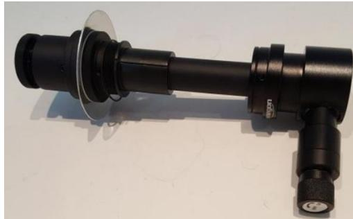
Hierzu muss der Polsucher am hinteren Ende, der Bereich mit den drei Madenschrauben, eingeführt werden. Zuvor unbedingt sicherstellen, dass die Madenschrauben nicht in die Buchse der Zusatzbeleuchtung hineinragen.
